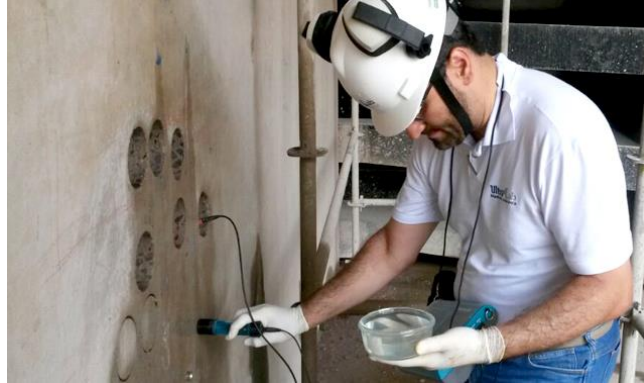
Figura 12- Ensaio de potencial de corrosão.
