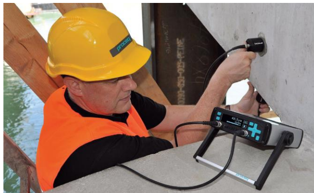
Figura 14 - Ensaio de ultrassom.
