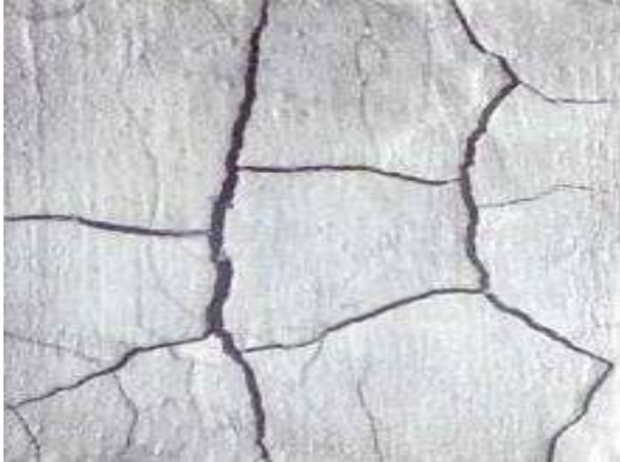
Figura 2: Deformação por retração e fluência.
