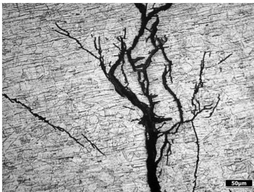
Figura 11: Corrosão sob tensão
