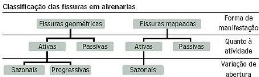
FIGURA 1 – Classificação das fissuras em alvenarias
