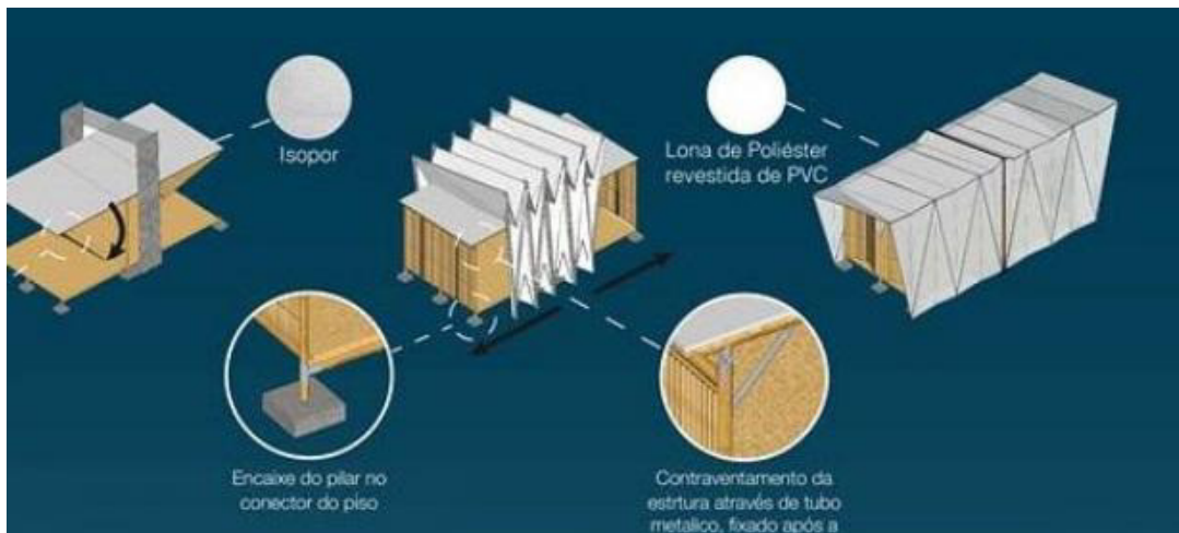
Figura 07 – Montagem do Abrigo, segunda etapa.
