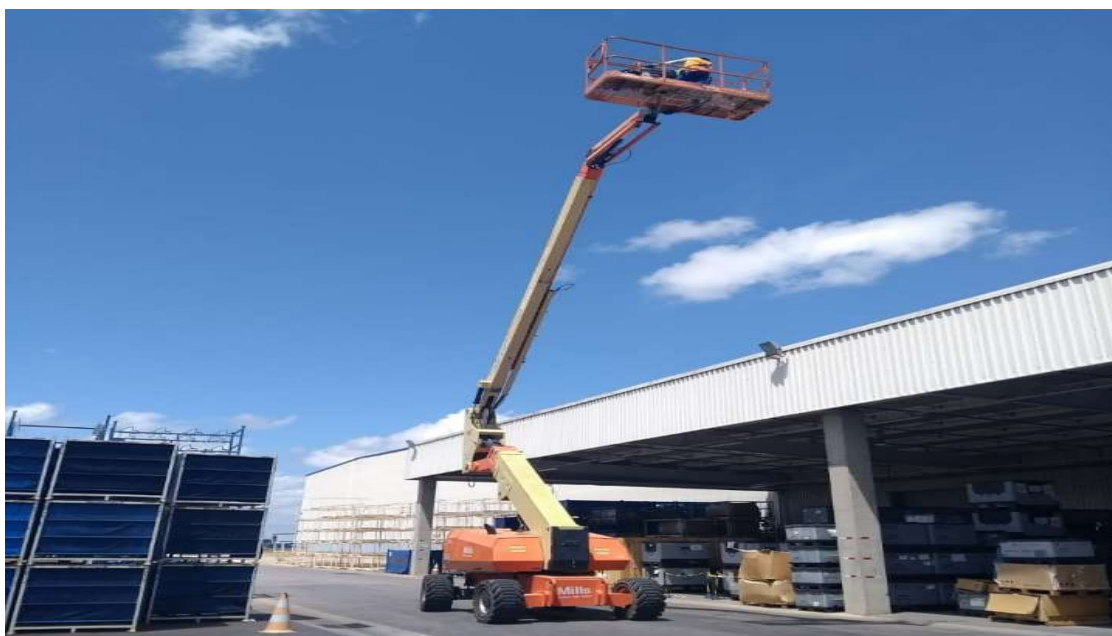
Figura 742: Plataforma de trabalho aéreo
