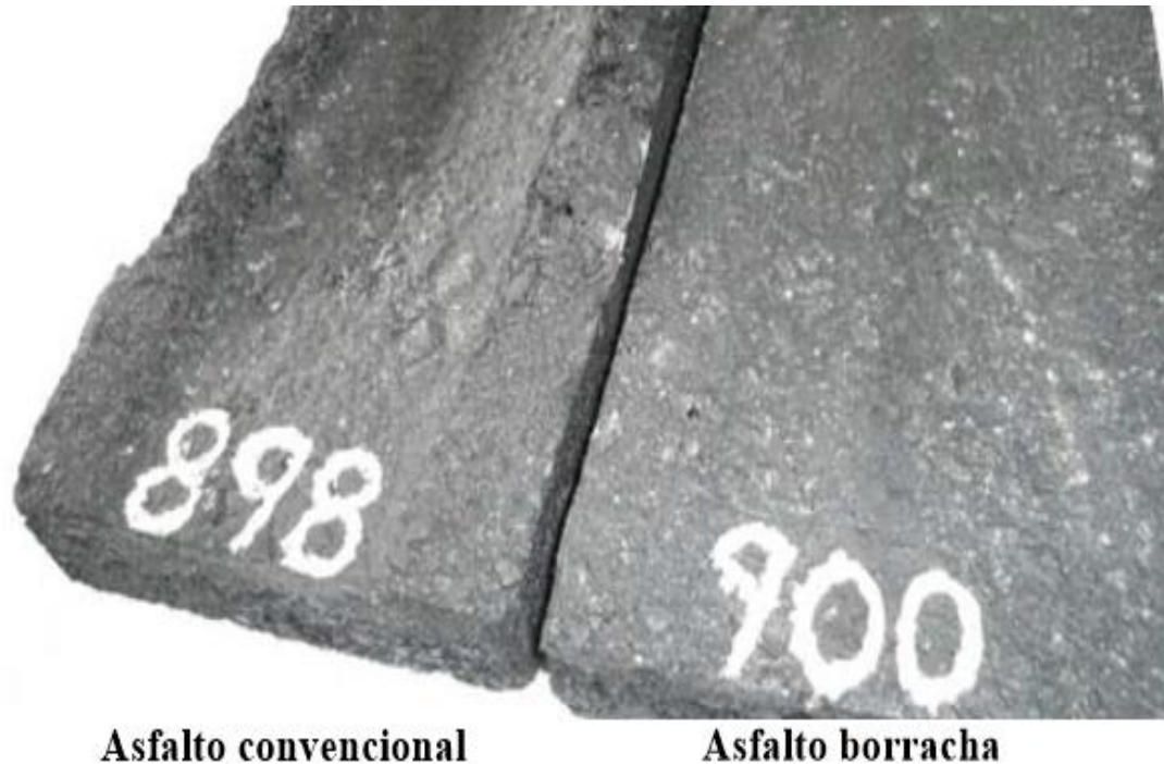
Figura 15 – Placas após serem sujeitas ao simulador de tráfego
