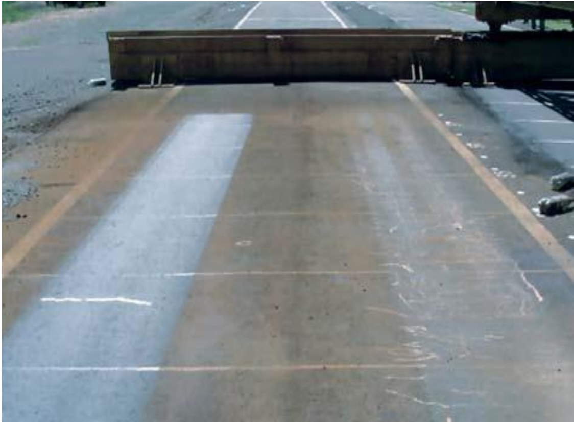
Figura 14 – Pistas após simulação de tráfego
