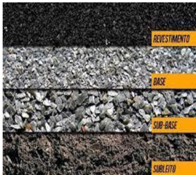
FIGURA 1 – Estrutura do pavimento
