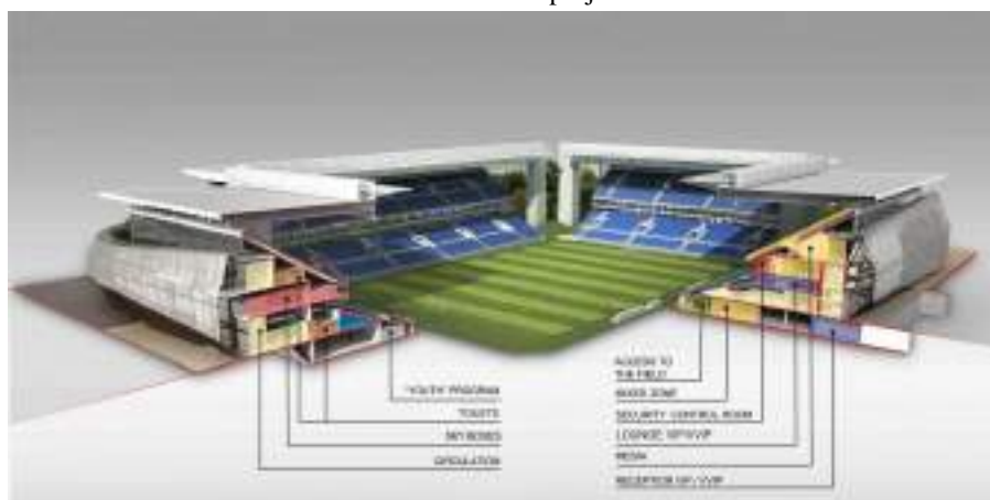
FIGURA 12: Detalhamento do projeto Arena Cuiabá
