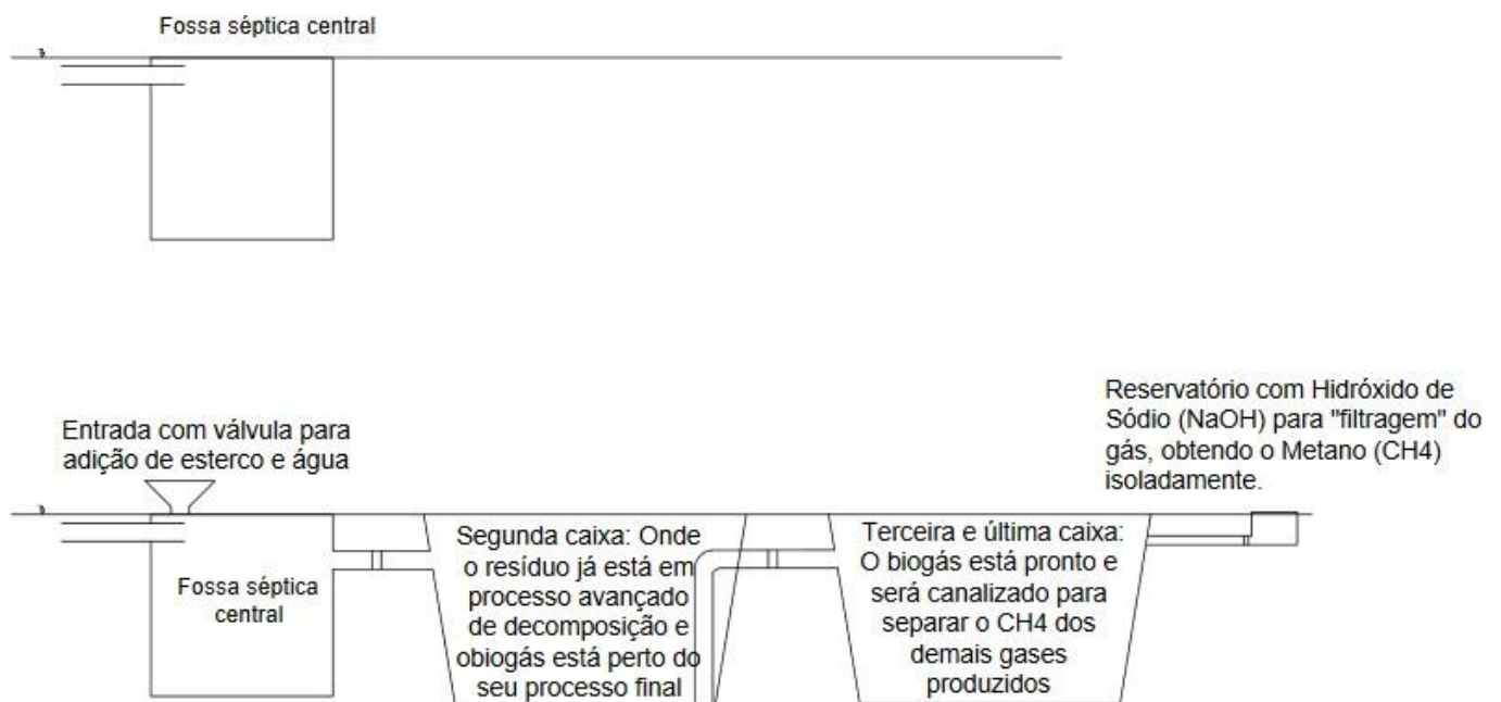
Figura 10 – Comparação entre o sistema atual (acima) e o sistema estudado (abaixo).
