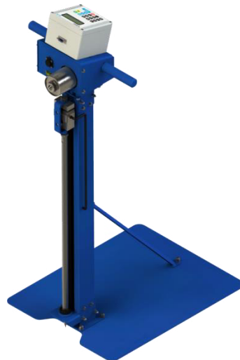
Figura 8 – Penetrometro utilizado na área do experimento para realizar as medições dos níveis de compactação.
